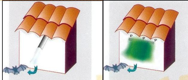
La malla debe ser fijada en las partes superiores, quedando libre en la parte baja de tal forma que el murciélagos pueda salir, pero no ingresar (ellos no poseen la capacidad de levantar la malla).
